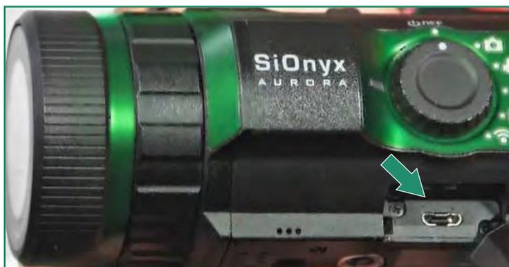
6. 使用随附的Micro USB将相机连接至开机的计算机或将其插入壁式充电器电缆。
