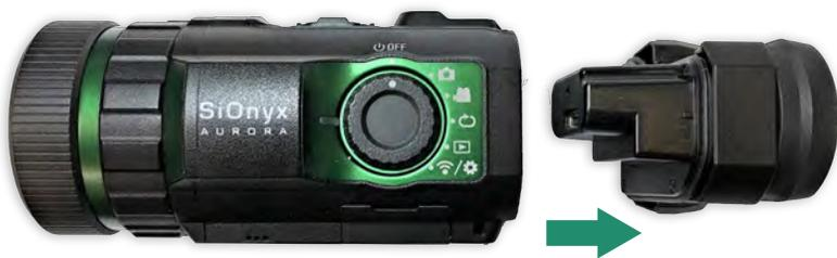
4. 将电池滑入电池槽。
